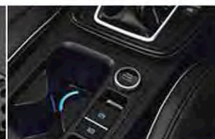
Frein De Stationnement Électronique Avec Maintien Automatique Et Modes De Contrôle De La Conduite Et De La Traction
